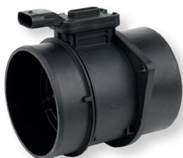
El caudalímetro de aire **mide la cantidad de aire que entra en el motor y transmite esta información a la unidad de control del motor (ECU)**. Estos datos son esenciales para **ajustar la inyección de combustible y garantizar una mezcla óptima de aire y combustible**, asegurando así una combustión eficiente, optimizando el rendimiento del motor y reduciendo las emisiones contaminantes y el consumo de combustible.
