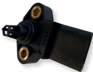
Le capteur de pression absolue du collecteur (MAP – *Manifold Absolute Pressure*) est un capteur utilisé dans les moteurs à injection électronique. Sa fonction principale est de **mesurer la pression à l'intérieur du collecteur d'admission afin de fournir une information essentielle au calculateur moteur (ECU)**. Ces données permettent d'ajuster l'injection de carburant et l'avance à l'allumage pour optimiser les performances du moteur et réduire les émissions polluantes.
