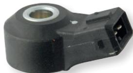
Le capteur de cliquetis (ou capteur de détonation) est un dispositif électronique permettant de **détecter les combustions anormales** (cliquetis) **dans le moteur d'un véhicule**. Ces cliquetis se produisent lorsqu'une explosion incontrôlée du mélange air-carburant survient, générant des ondes de choc nuisibles pouvant endommager les pistons, les soupapes et d'autres composants du moteur.
