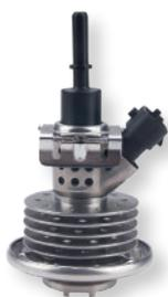
La función del sistema de inyección de **urea es inyectar un fluido llamado AdBlue®** (una mezcla de agua desmineralizada y urea) **en la corriente de escape** del vehículo antes de que los gases pasen por el catalizador SCR.
