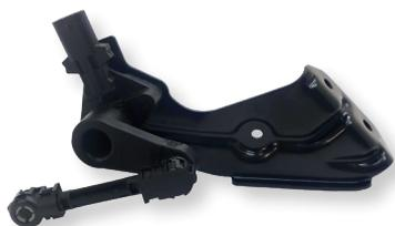
Situado cerca de la suspensión del vehículo, el sensor de altura de conducción es un **dispositivo compuesto por un brazo mecánico** que se mueve en respuesta a los cambios de altura del vehículo y un **sensor electrónico** que registra estos movimientos.
