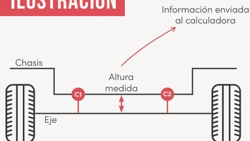
Cx Sensor de regulación estabilidad chasis-luces
