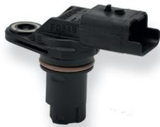
En combinaison avec le capteur de vilebrequin, le capteur d'arbre à cames permet **au calculateur d'identifier précisément la position du piston du 1<sup>er</sup> cylindre** et surtout le **cycle de combustion au niveau de celui-ci**. Cela permet au système de gestion moteur **d'injecter le carburant au moment adéquat dans les bons cylindres** (afin d'éviter une injection de carburant en phase d'échappement).
